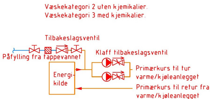
Prinsippskisse påfylling for varme/kjøleanlegg
